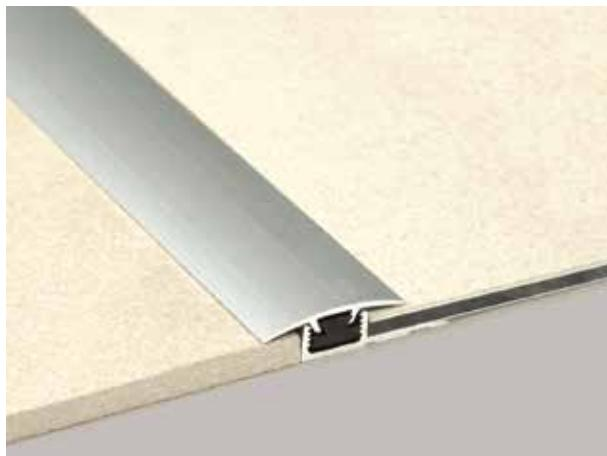
Profilé de jonction breveté pour planchers coplanaires. Innovateur, parce que l'ingénieux système avec clips en Resinil permet, en tournant, de rattraper aussi les petites différences de niveau jusqu'à 1,5 mm. Le système utilisé avec CLB60ANF (base) et CL40P (clip) permet aussi de raccorder des sols de 4 à 6 mm d'épaisseur. Il sert de joint de dilatation grâce à sa cavité interne qui permet aux sols situés en dessous de se déplacer de  $\pm 2$  mm.
